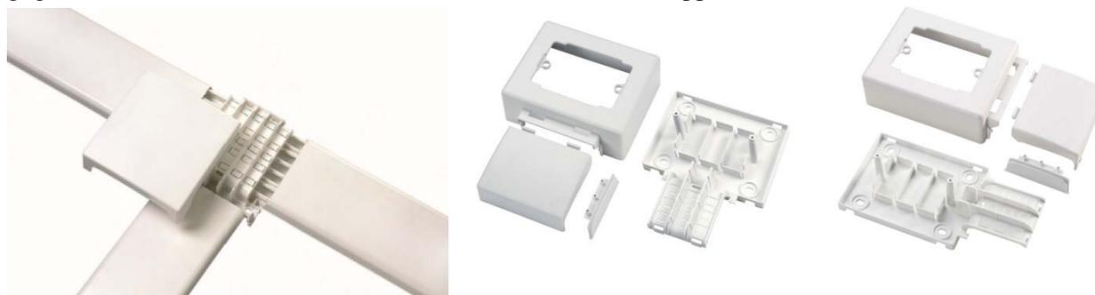
Fissare le griglie alla parete, procedere al montaggio del coperchio del battiscopa in modo che arrivi in battuta internamente al coperchio dell'accessorio. Procedere al montaggio a scatto delle calotte e dei coperchi forzandoli fino al punto di arresto negli appositi incastri. Assicurarsi del corretto posizionamento di tutti i punti di aggancio.
